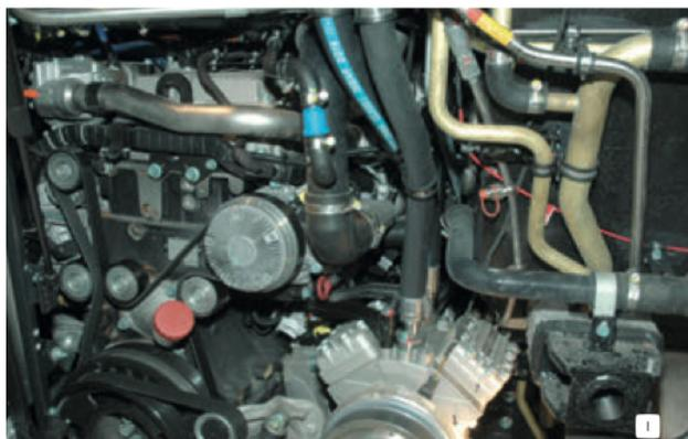
❶ Le contrôle du niveau d'huile moteur (et son remplissage) est aisé. Originalité : il n'y a pas ici d'alternateur. Ce rôle est dévolu à l'alternodémarrateur et aux super-condensateurs.
