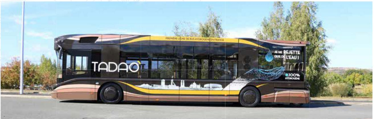
En conservant toute l'architecture de la gamme, SAFRA a adapté un système hydrogène sur la chaîne de traction électrique initiale. La pile à combustible de 30 kW fournie par Symbio/Michelin, associée aux 30 kg d'hydrogène embarqués, permettent de couvrir une autonomie supérieure à 350 km. Toujours aussi attractif et innovant le Businova H<sub>2</sub> est un véhicule zéro émission répondant parfaitement à la Loi de transition énergétique.
